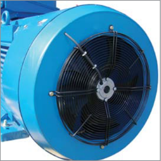
Рис. 2.2. Узел независимой вентиляции
