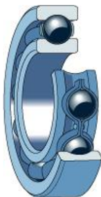
Рис. 5.1. Подшипник с керамическими шариками
