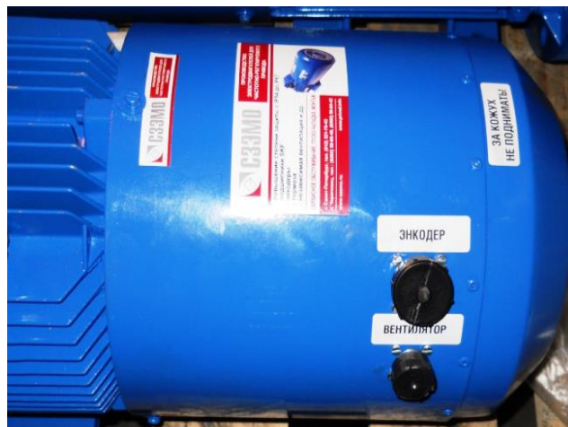
Рис. 2.3. Заглушки для защиты разъемов
