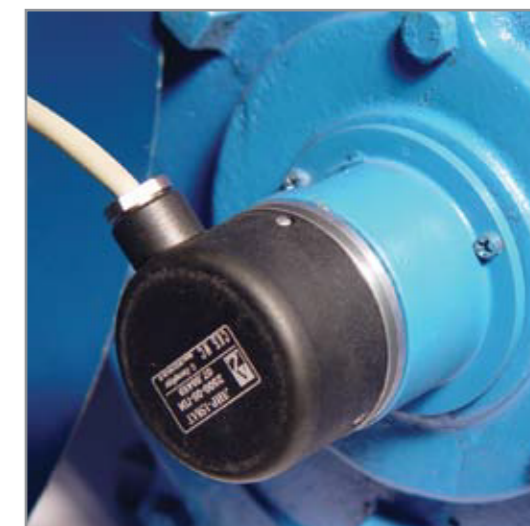
Рис. 3.1. Энкодер на валу двигателя
